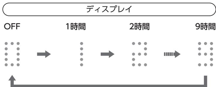
③ 時間を設定したあと、ディスプレイの表示が点滅から点灯 (風量表示) に切り替わると、設定完了となります。
