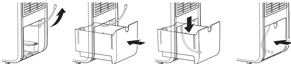
水タンクを取り付けると、ディスプレイの表示とすべてのランプが消灯し待機状態となります。操作部またはリモコンの『電源』ボタンを押すと、引き続き運転を開始します。
