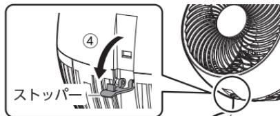
ストッパーは意図せずに外れてしまうことを防止するため、固めに設定しております。外れにくいときは、隙間に樹脂ヘラなどを差し込んで、ストッパーを起こしてください。
