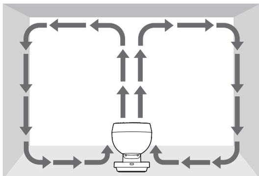
天井に風を送り、部屋全体の空気を循環させます。
