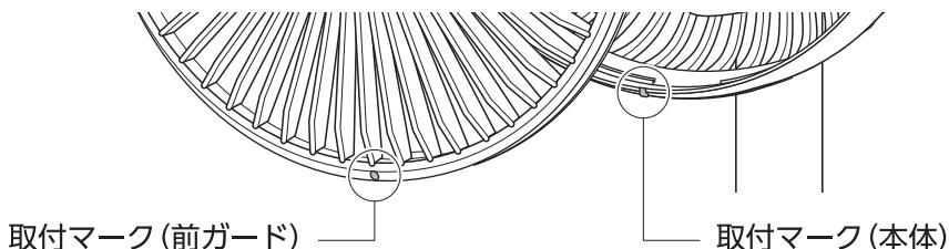
② 前ガードのフックと本体の切り欠きの位置を合わせて取り付けます。
