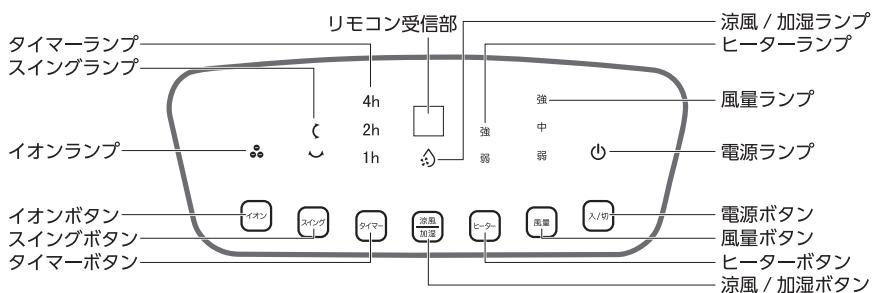
※入／切ボタンを押して、電源をオンにすると、前回電源を切ったときの設定で運転が開始します。
